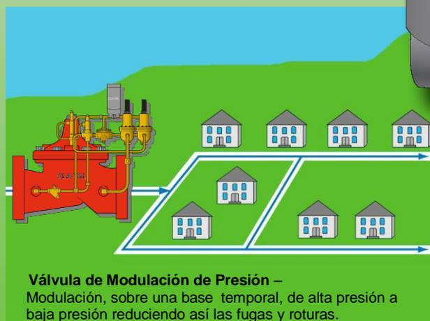
**Válvula de Modulación de Presión** - Modulación, sobre una base temporal, de alta presión a baja presión reduciendo así las fugas y roturas.
