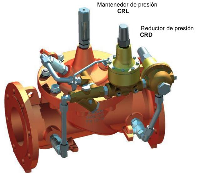
La SERIE CLA-VAL 90 reduce la presión aguas arriba a una presión aguas abajo inferior y constante sin incidencia de las fluctuaciones de caudal y/o de presión aguas arriba.
